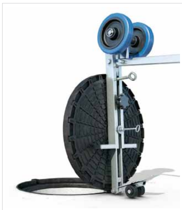
Apertura chiusino incernierato con blocco di sicurezza antichiusura mediante Carrello SD61 con estensione a pedale
