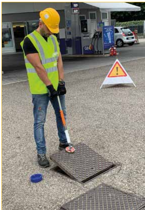
Utensili di categoria 3 ATEX adatti ad essere utilizzati in luoghi classificati ZONA 2.
