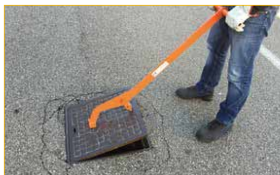
Nell'operazione di sollevamento la lunghezza della leva limita lo sforzo dell'operatore.
