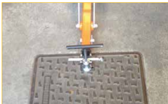
Fase 2: ingaggio della leva nel morsetto.
