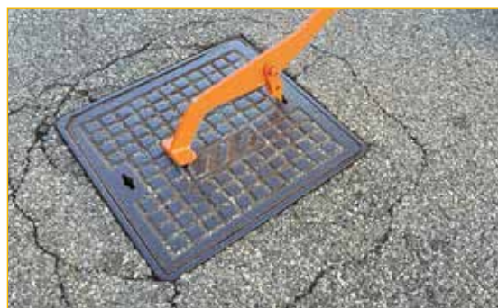
Inserimento del dente nell'asola e rotazione di 90°.
