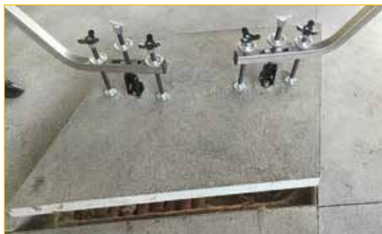
Piedini dei puntoni laterali snodabili per garantire un appoggio perfetto ad ogni superficie.
