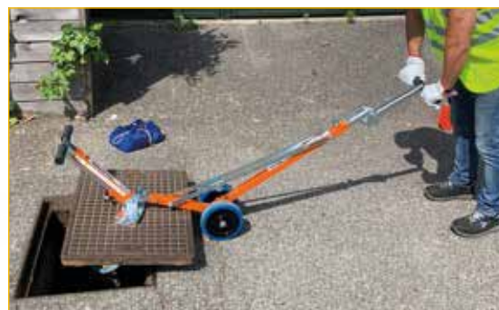
Utilizzo 2: sollevamento con leva pieghevole APS90 - APS80.
