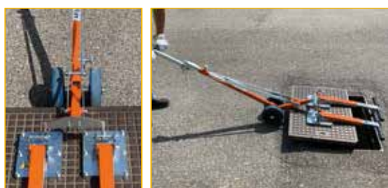
Utilizzo 2: sollevamento con due CL10 in parallelo uniti con ponticello di collegamento su coperchi pesanti.
