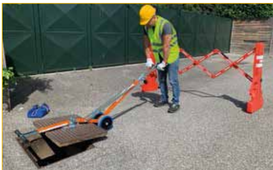
Utilizzo 2: sollevamento con leva pieghevole APS90 - APS80.
