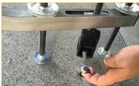
Tirante centrale con gancio rotante e scorrevole. Nel particolare visibile aggancio centrale femmina
