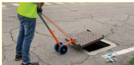
Utilizzo 3: in combinazione con set morsetti meccanici ad aletta e gancio.
