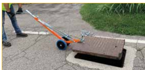
Utilizzo 3: sollevamento meccanico con morsetti di bloccaggio.
